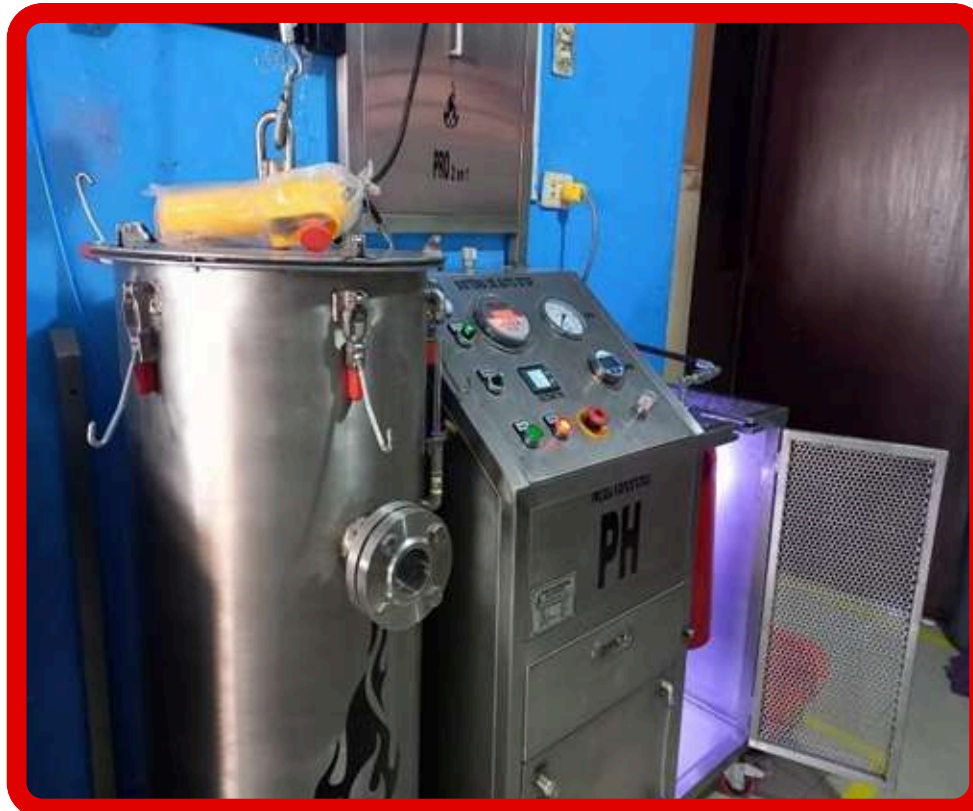
MAQUINA AUTOMATIZADA DE PRUEBA HIDROSTATICA DE ALTA Y BAJA PRESIÓN
